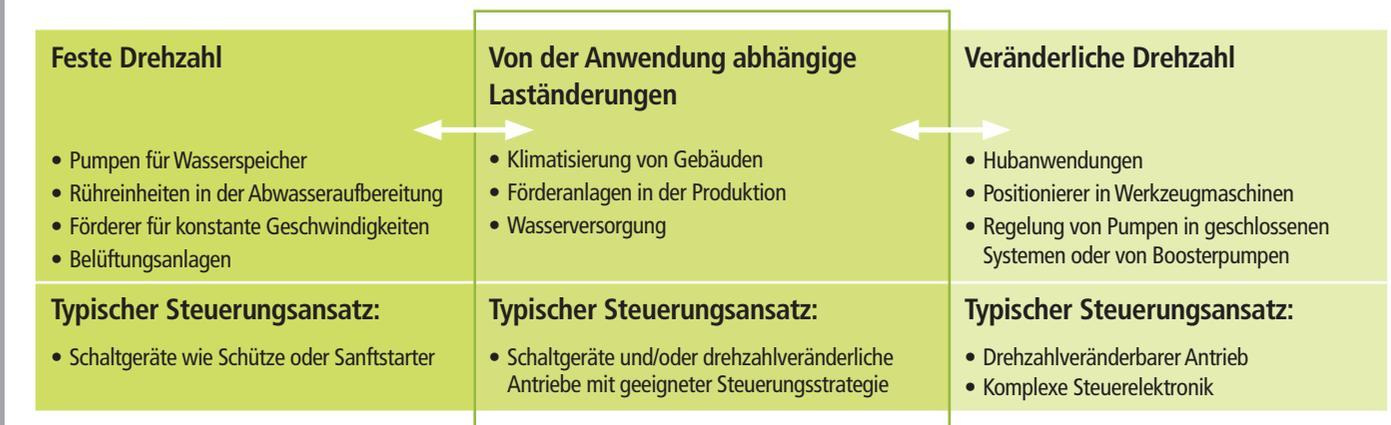
Antriebssysteme sind oft gekennzeichnet durch verschiedene oder sich stetig ändernde Lastverhältnisse. Diese Lastverhältnisse ergeben sich aus den Drehzahl- und/oder Drehmomentanforderungen, die der Motor abdecken muss. Beide Lastkomponenten – Drehzahl und Drehmoment – sind also zu betrachten, um die Lastverhältnisse des Antriebssystems zu beschreiben.
